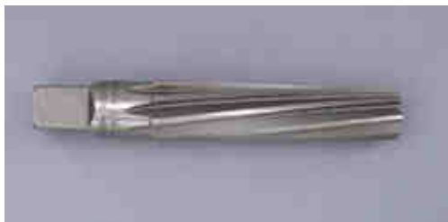
Obr. 19 Kužeľovitý výstružník pre kužeľový otvor (Morse)
